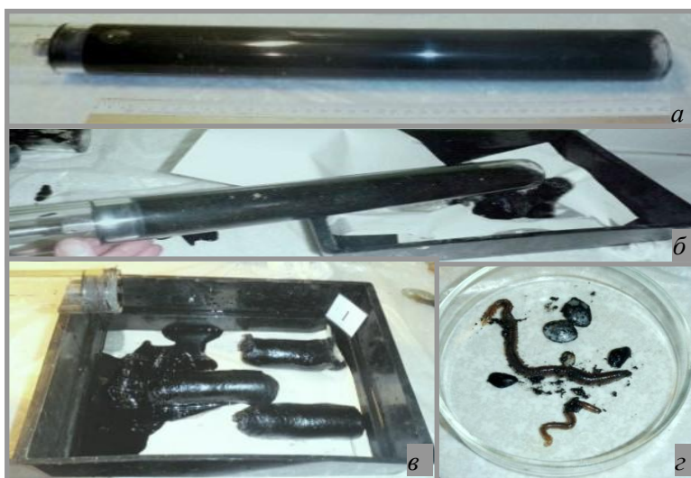
Рис. 2. Пробоотборник, наполненный донным грунтом (а, б), керн, выдавленный из пробоотборника (в); содержащаяся в пробе интерстициальная фауна полихет и моллюсков (г)
